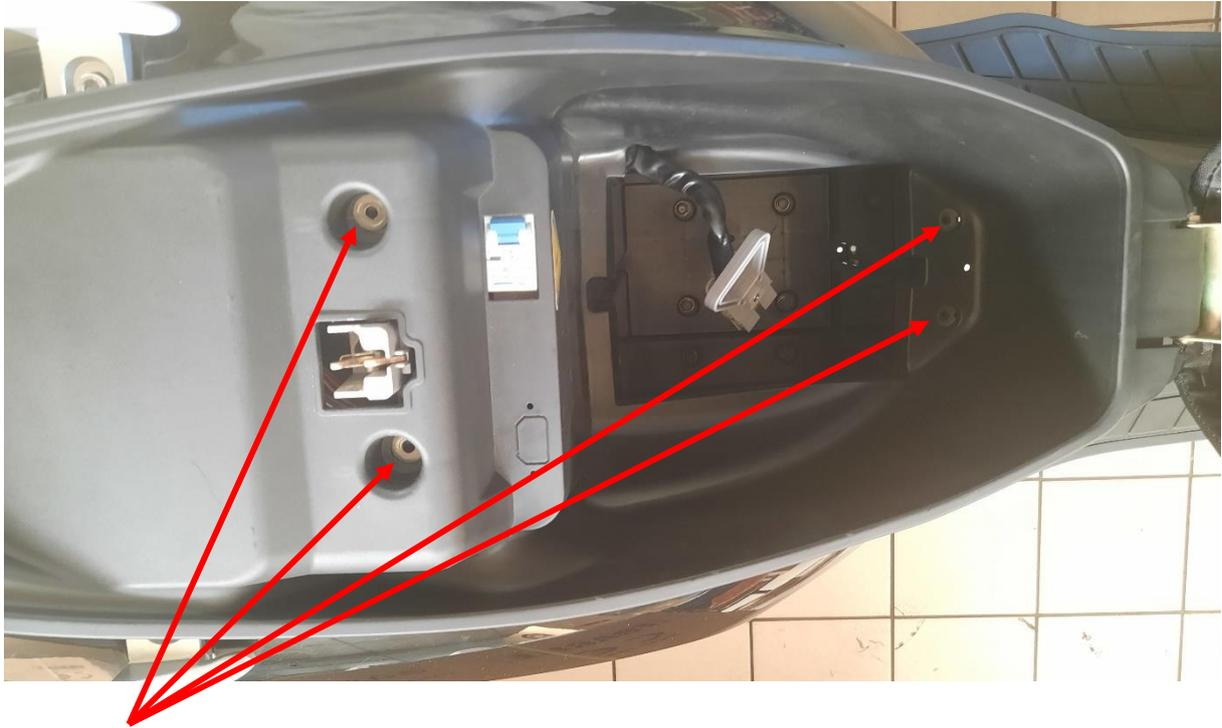
Une fois la batterie sortie il faut retirer les 4 vis qui tiennent le bac de cellule
