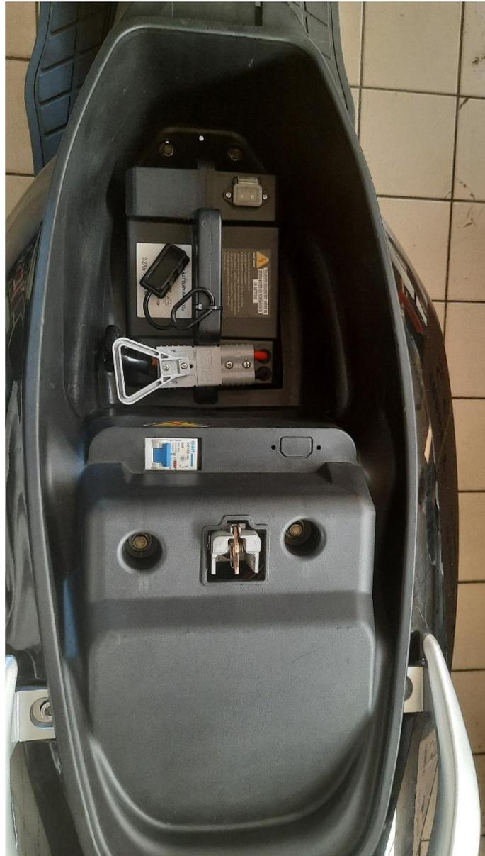
Avant de commencer nous allons couper le disjoncteur et allumer le contact afin de vider le contrôleur puit par la suite nous pouvons débrancher la batterie
