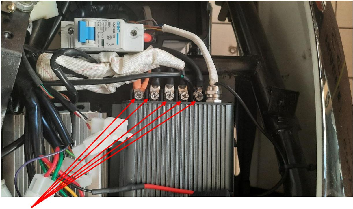
Après avoir démonté la serrure nous avons accès plus facilement aux vis du faisceau moteur ET BATTERIE
