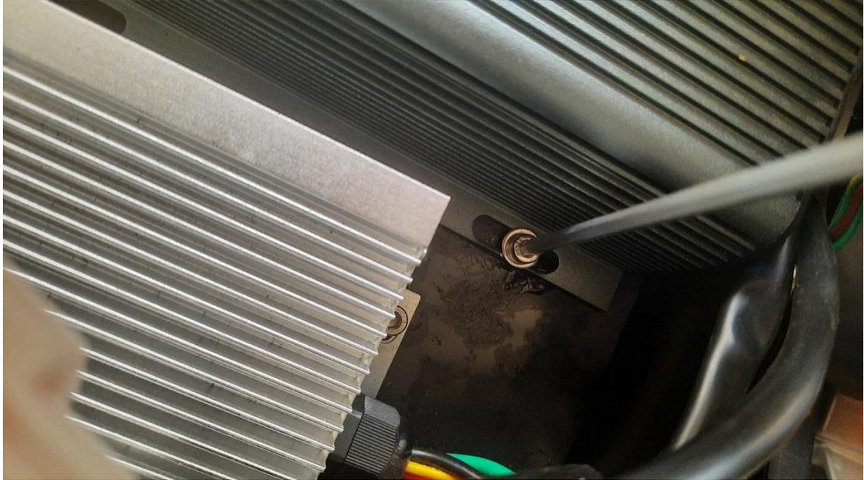
Il vous reste plus qu'à retirer les vis de fixation du contrôleur
